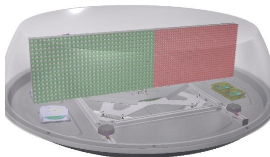
Bildunterschrift: CAD-Ansicht der landmobilen Antenne unter einem Radom Quelle EPAK GmbH
